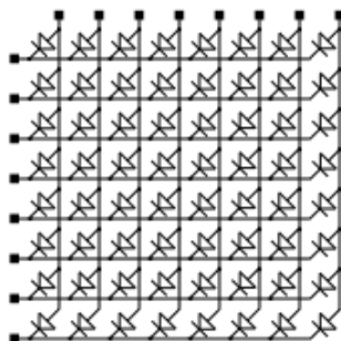
Obr. 1 - Vnitřní schéma LED zapojených v matici se společnou katodou
